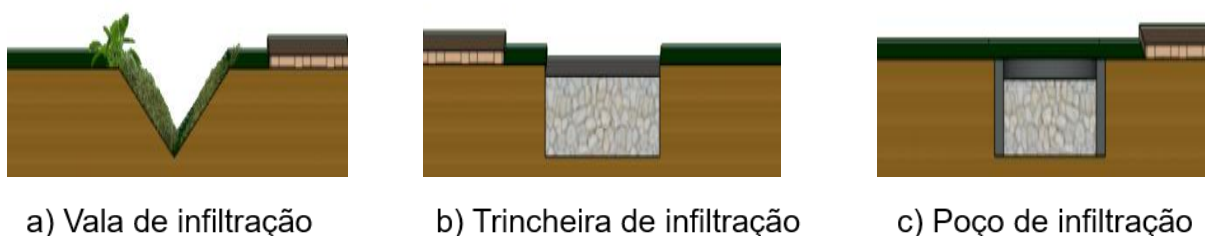
Figura 7 – Estruturas de infiltração
