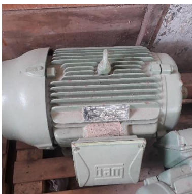
Item 14: Motor Weg 50 cv Patrimônio: Sem Patrimônio
