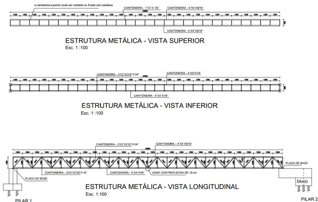
**Figura 7: Projeto executivo da estrutura metálica**
