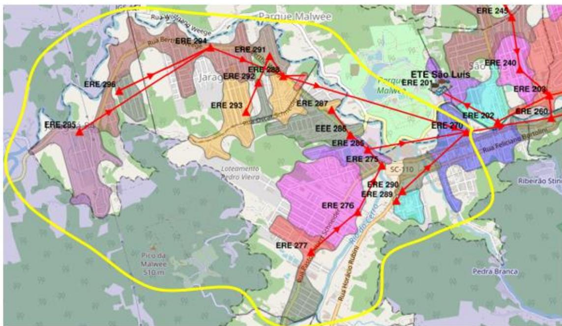
**Figura 1: Área de Contribuição para a Estação de Recalque de Esgoto ERE 270**
