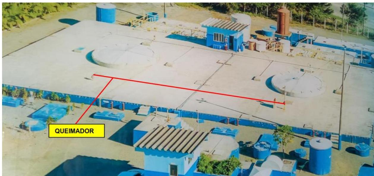
Imagem 01 – Tubulações a serem instaladas e o posicionamento do sistema de queima de biogás.
