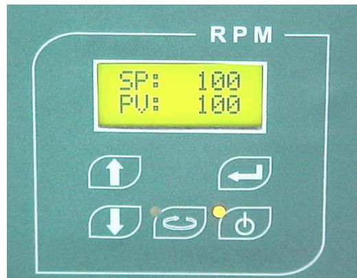
Figura 1. Painel do aparelho de jartest, modelo LDB
