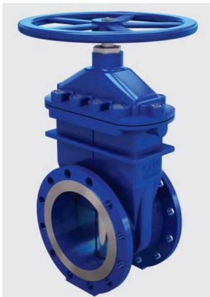
Figura 1 - Ilustração Válvula de gaveta flangeada com cunha revestida de borracha, DN 400 e PN16, comprimento flange a flange de 310 mm.
