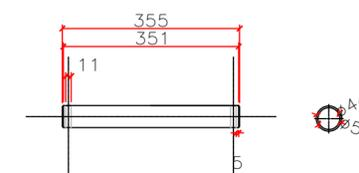
8- EIXO DO ROLETE PARA TUBO Ø400MM (1 PEÇA POR SUPORTE)
