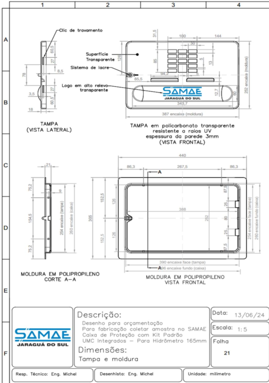
**ANEXO IV - DIMENSÕES E COMPATIBILIDADE ENTRE CAIXA PADRÃO E MOLDURA**
