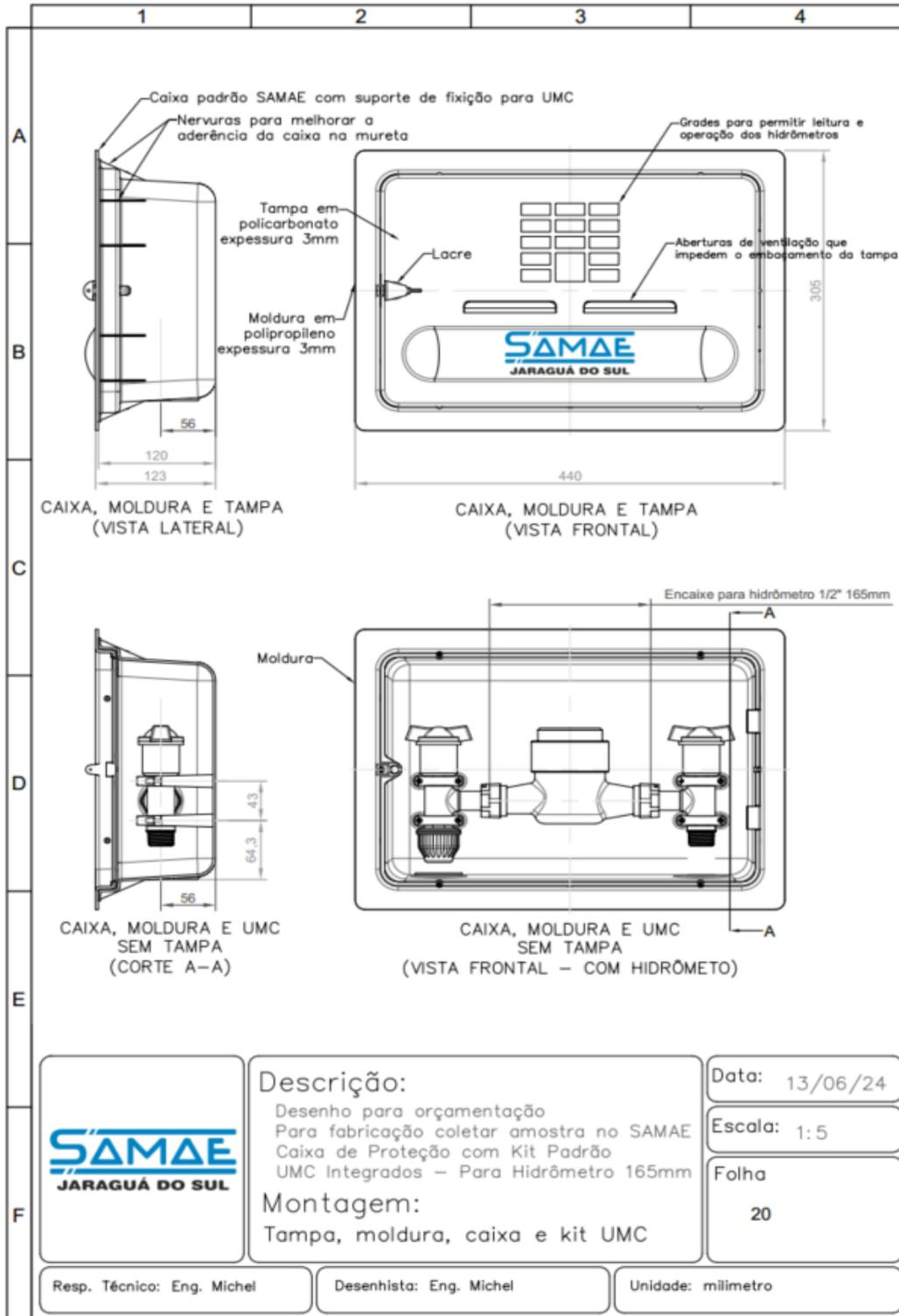
**ANEXO II - DESTAQUE NAS ÚNICAS MUDANÇAS QUE DEVEM SER FEITAS NA AMOSTRA PADRÃO DO SAMAE (grades e aberturas de ventilação da tampa e a profundidade do suporte de fixação do kit UMC)**
