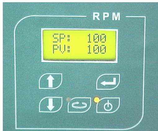
**Figura 1. Painel do aparelho de jarteste, modelo LDB**
