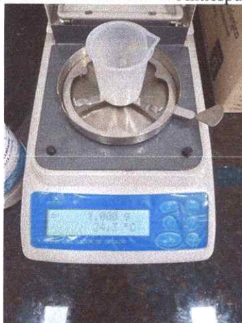
Figura 2: quantidade de amostra de Antiespumante Ultrasil Defoam – Base Silicone medida.
