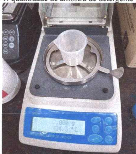
Figura 1: quantidade de amostra de detergente medida.
