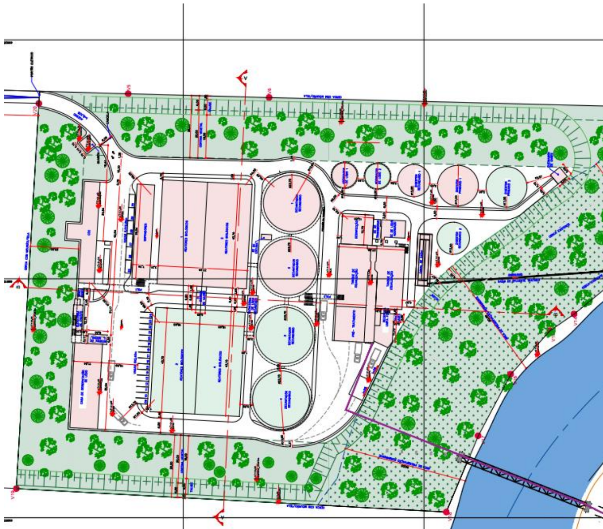
Imagem 01 – Planta da estação de tratamento, em vermelho a primeira etapa e verde a segunda etapa.
