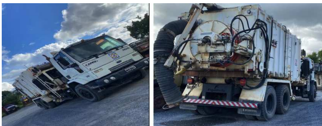
Figura 33 – Caminhão hidrojato utilizado no serviço de limpeza de bocas de lobo
