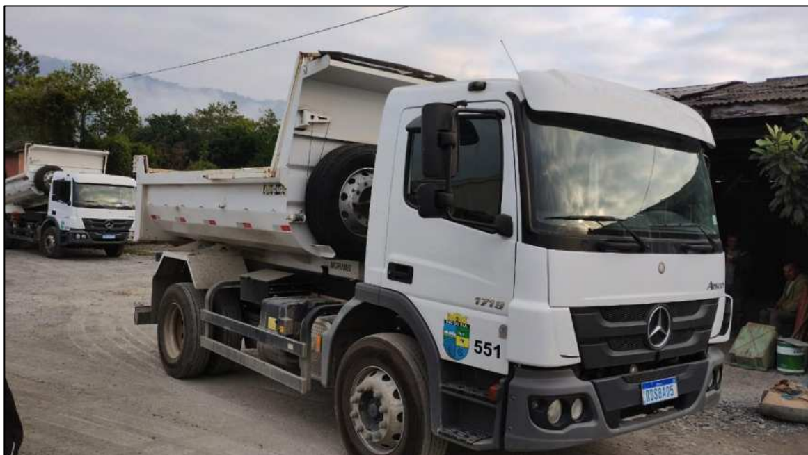
Figura 31 – Transporte de RLP - caminhão caçamba de 6 m 3
