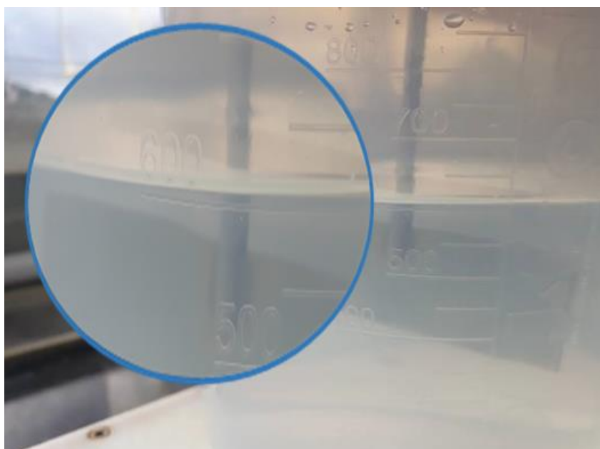
Figura 5: Ausência de espuma no interior e paredes da solução
